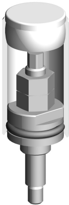
Abb. 40: Hubbegrenzung in Geschlossenstellung
