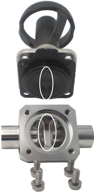
Abb. 21: Dichtsteg von Membrane und Gehäuse
