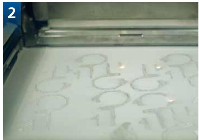
Procédé de fabrication additive fusion laser sur lit de poudre
