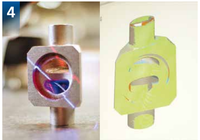
Vermessung mit 3D-Scanner als Teil der Qualitätssicherung Surveying with 3D scanner as part of quality assurance
