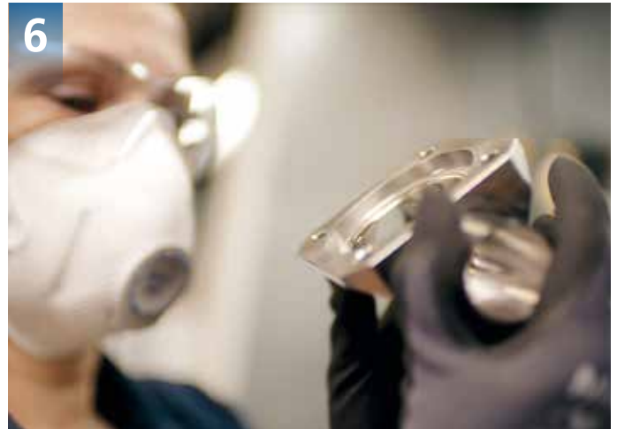
Bearbeitung der Innenoberflächen und Elektropolieren – je nach Kundenwunsch Machining of the inner surfaces and electropolishing – based on the customer's requirements
