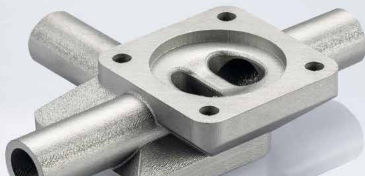
Bloc de vannes multivoies fabriqué par impression 3D, avant finition et traitement de surface/Válvula de bloque multipuerto de fabricación aditiva, antes del acabado y el tratamiento de la superficie
