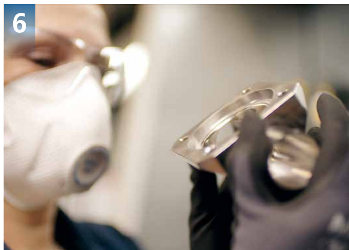
Usinage des surfaces intérieures et électropolissage – réalisés selon les exigences du client Mecanizado de las superficies interiores y electropulido, según los requisitos del cliente
