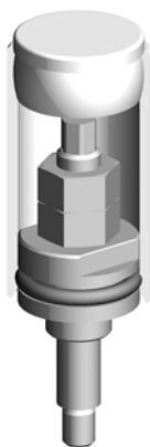
III. 40: Limiteur de course en position de fermeture
