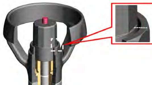
Abb. 13: Einstellhülse bündig mit Oberkante des Handrads
