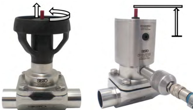
Abb. 17: Membranventil/LAP in Offenstellung bringen
