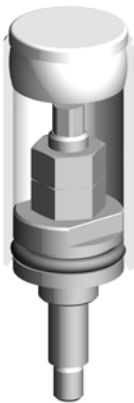
Abb. 40: Hubbegrenzung in Geschlossenstellung
