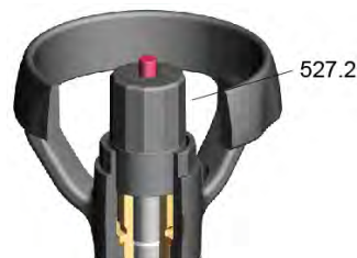
Abb. 12: Endlageneinstellung in Offenstellung
