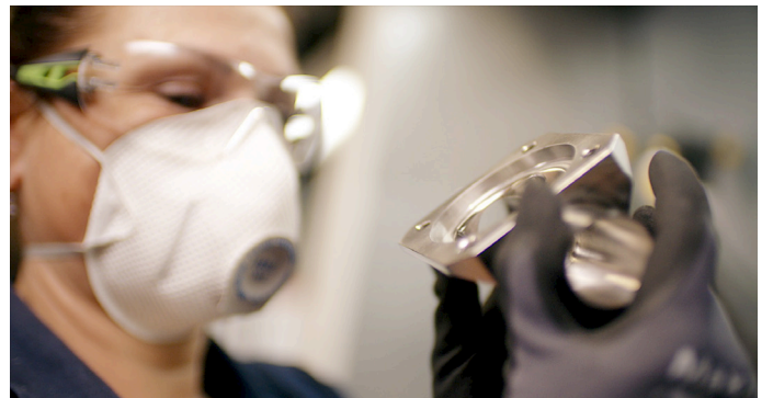
6. Usinage des surfaces internes et polissage électrolytique (selon les besoins du client)
