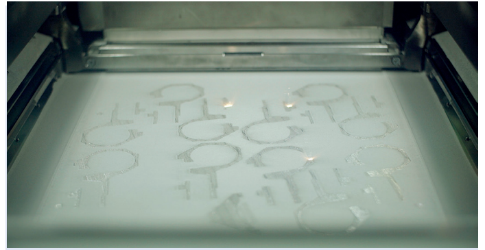
2. Additive Fertigung im Pulverbett-Schmelzverfahren
